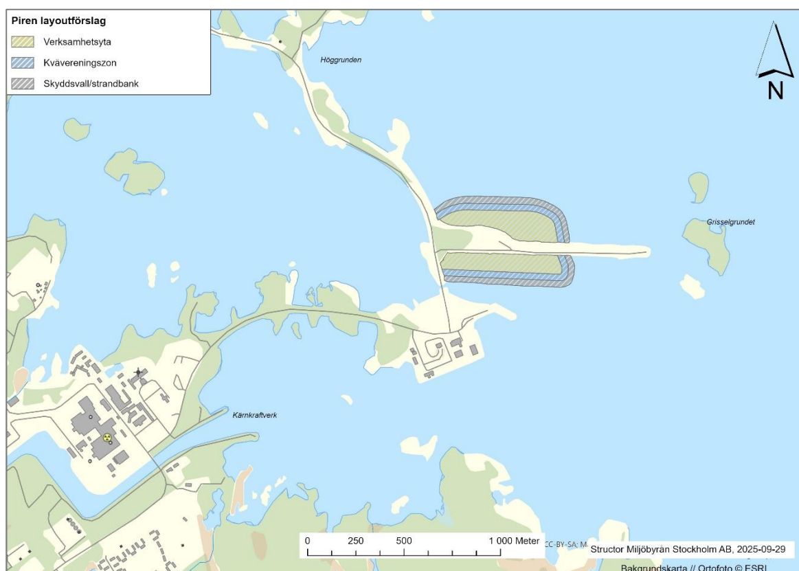
Figur 4-15. Utformning av föreslagen utfyllnad norr och söder om piren samt område med högt naturvärde (grönt område) som utformningen anpassats till. De ljus beigea områdena utgör befintligt markområde.
