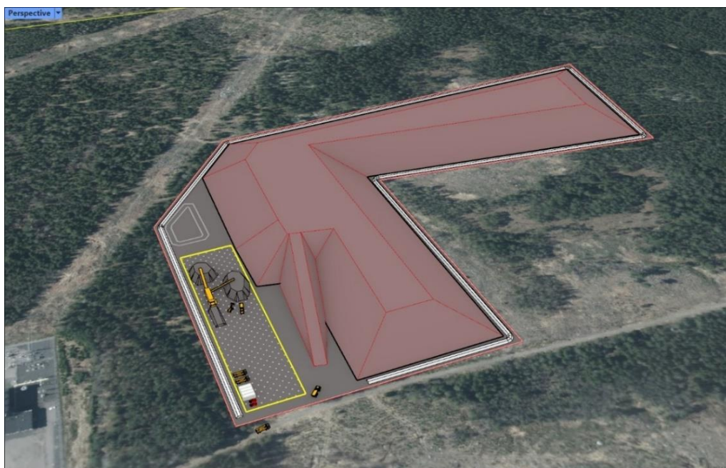
Figur 2-2. Förslagsskiss på bergupplaget med föreslagen disponering av dess olika verksamheter (logistikyta med arbetsbodnar, krossverksamhet och lastning (gult), lakvattendamm (ljusgrått)).
