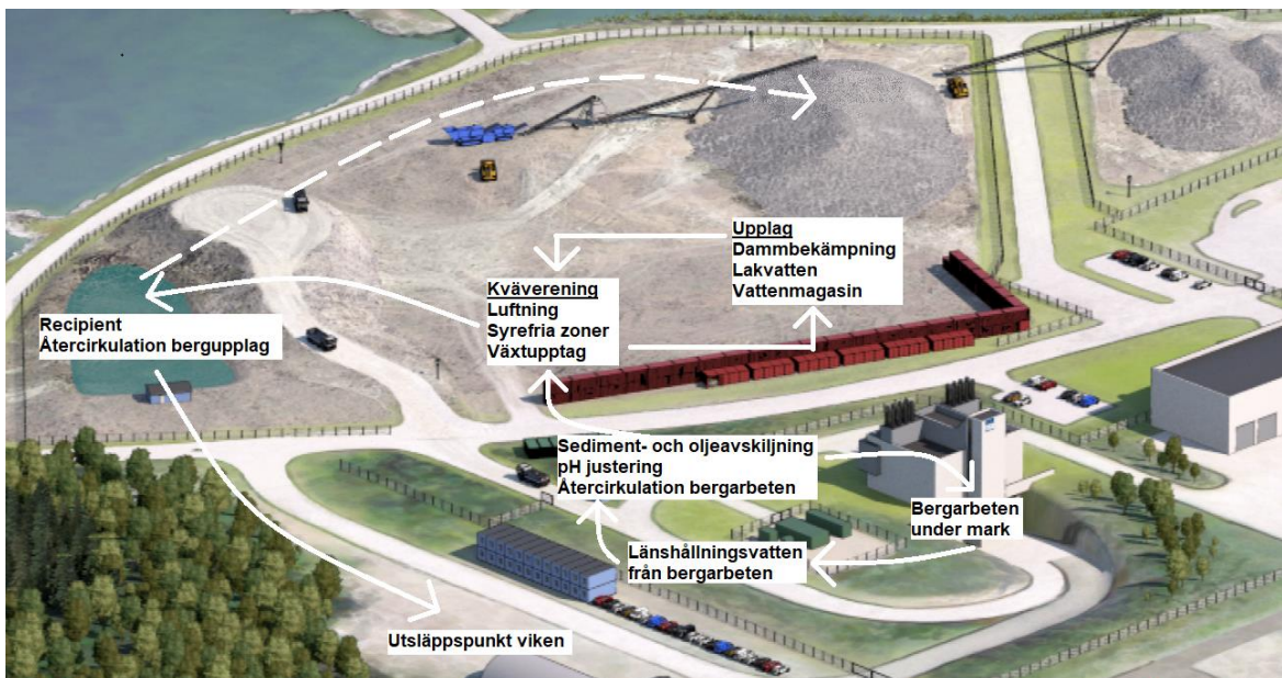
Figur 3–1. Länshållnings- och lakvattenhantering via kväverening, Stora Asphällan.
