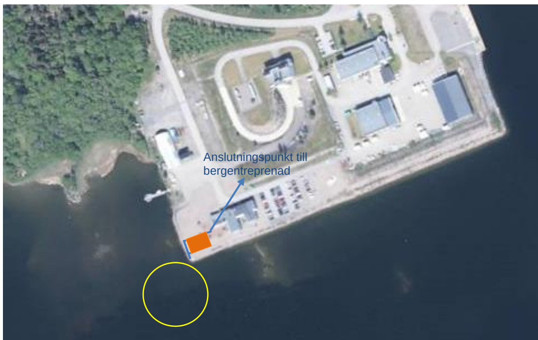
Figur 5-5. Övergripande system för havsvattenuttag vid Stora Asphällan. Intagsledning och utläppsledning för returvatten anläggs i vattenområdet inom gul ring. Yta för eventuell avsaltningsanläggning markerad i orange.
