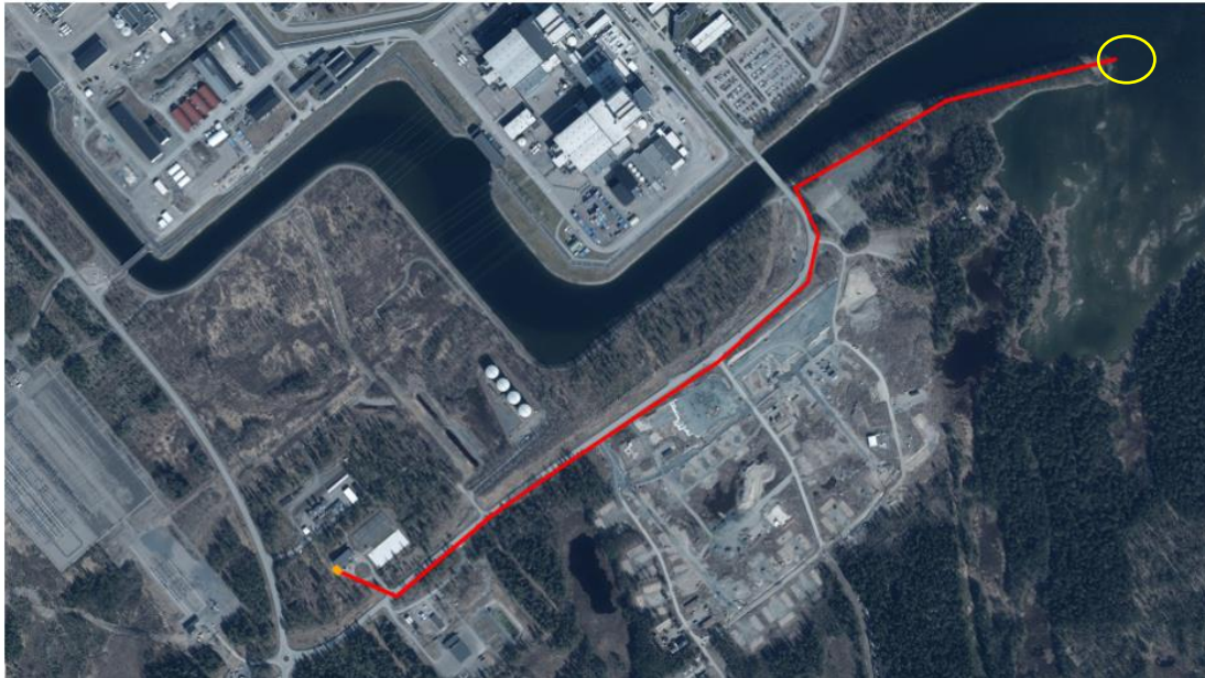
Figur 5-6. System för havsvattenuttag vid Söderviken. Intags- och utsläppspunkt förläggs inom gul ring. Röd linje visar ungefärlig sträckning för planerade ledningar på land till FKA:s reningsverk (yta markerad i orange).
