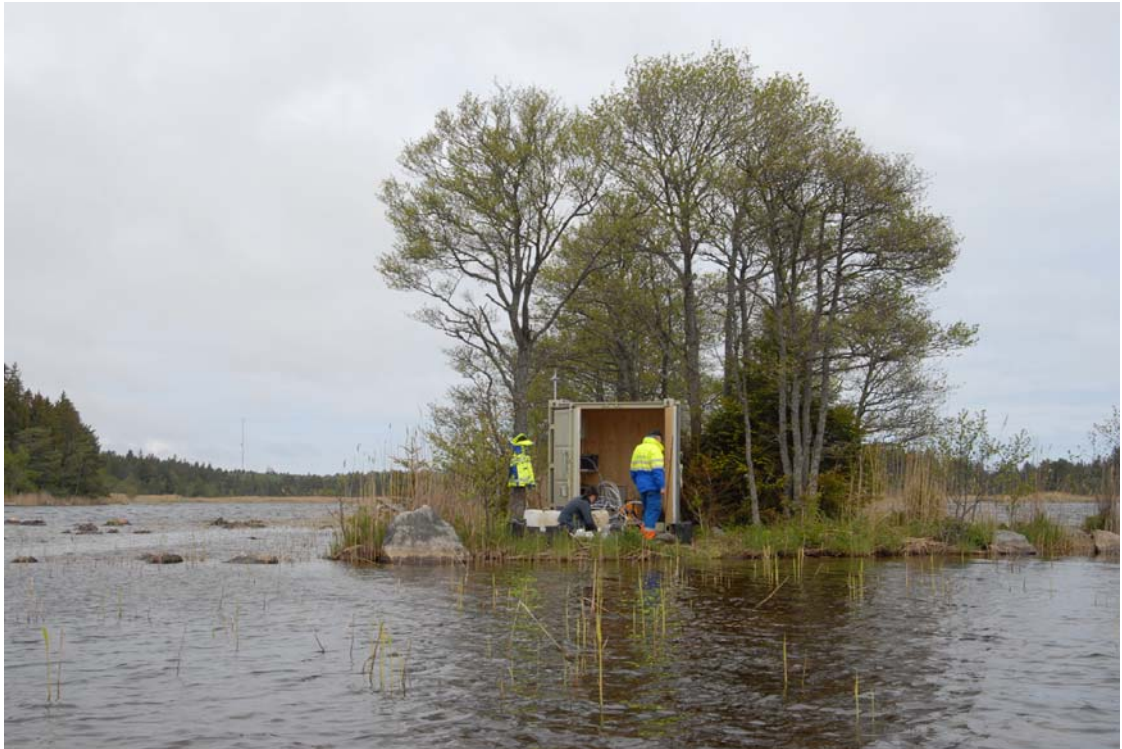
"Provtagningshytt" på Bolundsfjärdens enda ö. Här mäts grundvattentryck och provtagning av grundvattnet sker vid flera tillfällen varje år. Solceller förser mätutrustningen med ström. Foto: Alf Sevastik
