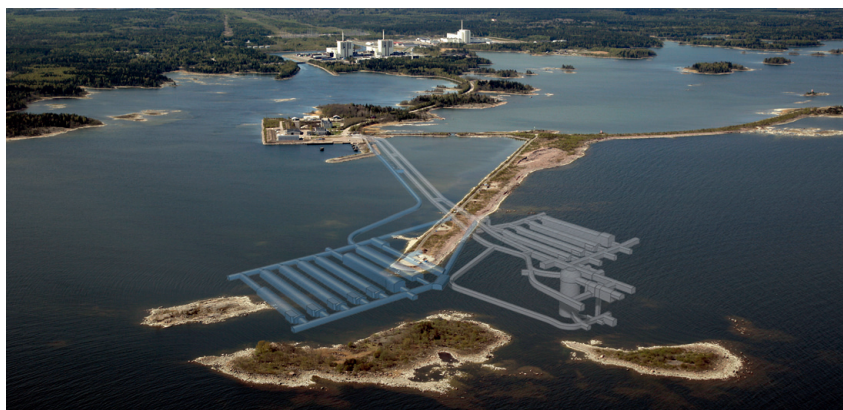
Figur 4-1. Befintlig SFR-anläggning (ljusgrå) och nuvarande planer för full utbyggnaden (blå). Observera att den slutliga utformningen av SFR ännu inte är fastställd. Största delen av utbyggnaden planeras utgöras av bergsalar anpassade för lågaktivt avfall (BLA).
