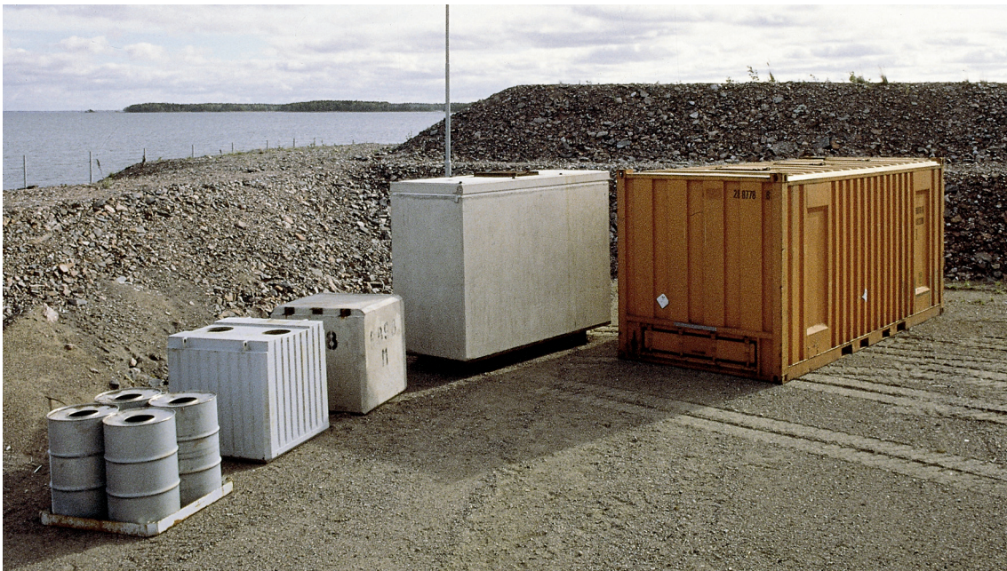
Figur 3-3. Avfallsbehållare för kortlivat låg- och medelaktivt avfall. Från vänster till höger: plåtfat, plåtkokill, betongkokill, betongtank och ISO-container.
