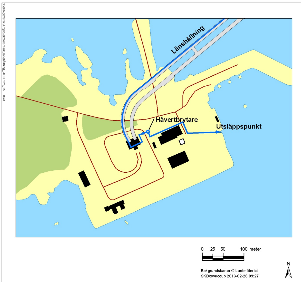
Figur 9-3. Figur visande nuvarande omhändertagande av länshållningsvatten från SFRs underjordsdelar.
