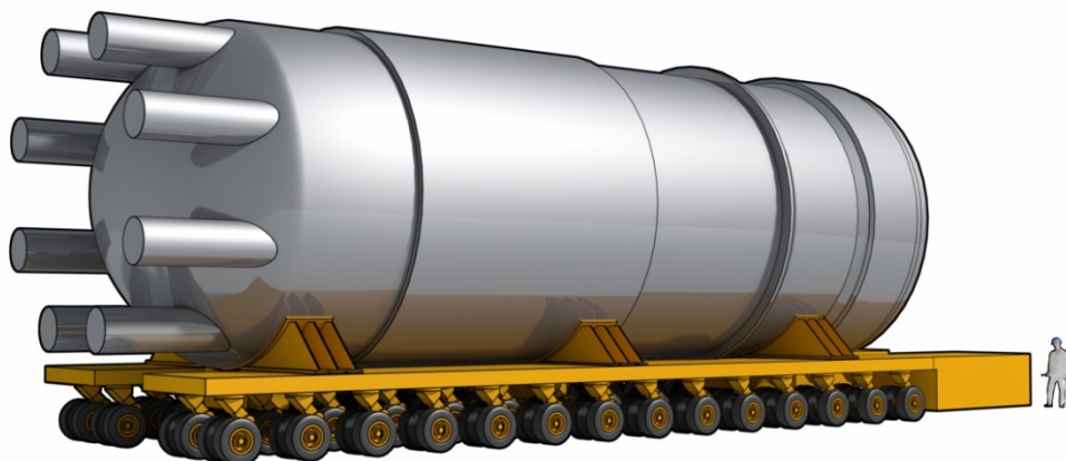
Figur 5-18. Fordon av typen SPMT under transport av reaktortank.
