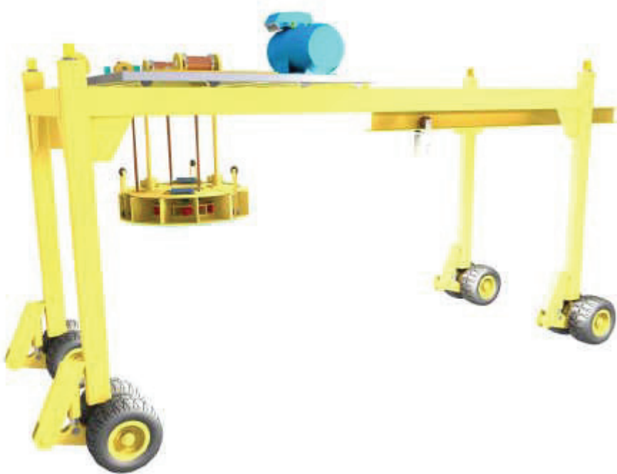
Figur 2-10. Bockkran (preliminär utformning).
