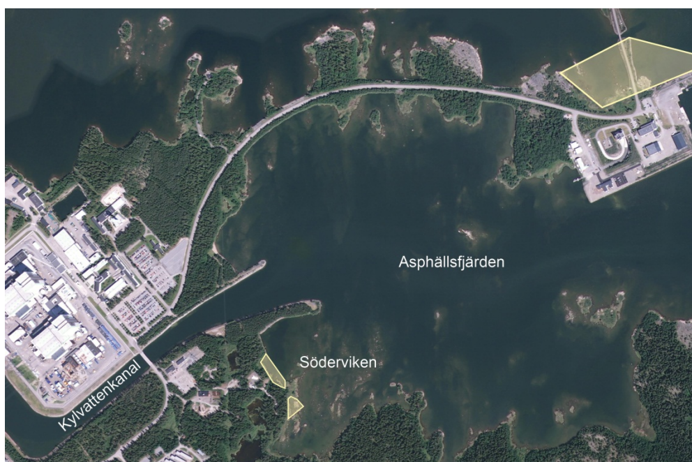
Figur 5-3. Vattenområden i Söderviken där utfyllnad planeras för att skapa utrymme för Kärnbränsleförvarets ovanmarksanläggning (två små gula områden i Söderviken). I figuren visas även utfyllnad av vattenområden vid den planerade utbyggnaden av slutförvaret för kortlivat radioaktivt avfall (SFR), vilket visas som större gult område norr om Asphällsfjärden.
