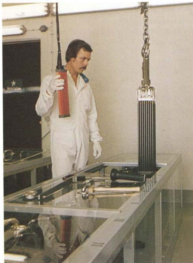
Inspektion av ett nytt bränsleelement i bränsleförrådet.
