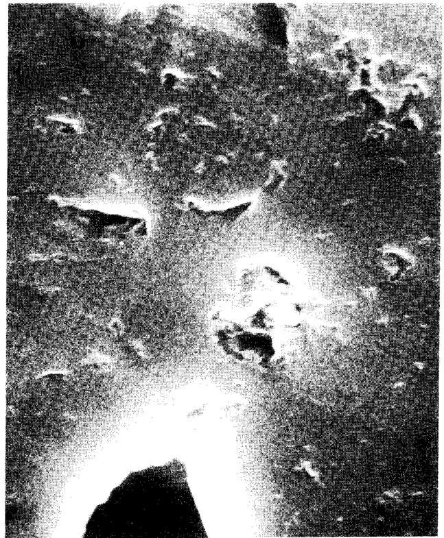
Fig. 3 och 4 LD-massa. Ytstrukturen efter polering. 300 x resp. 5 000 x
