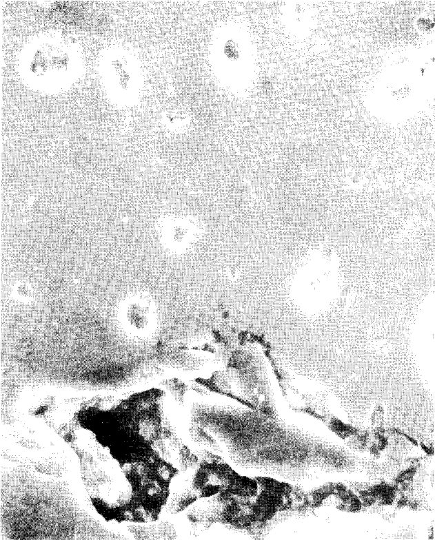
Fig. 1 Före behandlingen i kungsvatten vid upplösning av guldsiktet. LD-massa. 1 000 x
