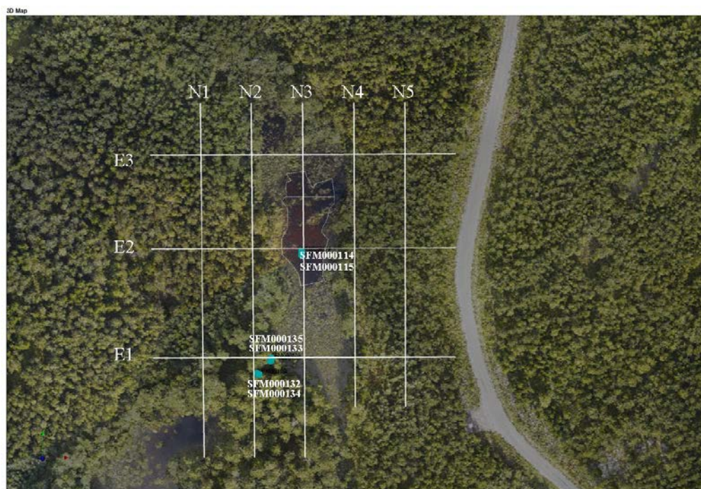
Figur 3-1. Karta som visar de åtta mätprofilernas geografiska läge (vita heldragna linjer) samt positionen på de sex borrhål som användes som stöd vid tolkningen av resistivitetsdata.
