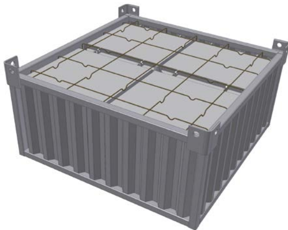
Figur 8-11. Behållare för fyra kokiller; lastad. Armering för kringgjutning synlig.
