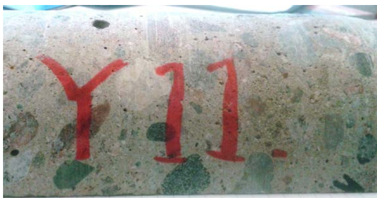
Figur 22-1. Borrkärna uttagen ur betongbarriären i bergssal för medelaktivt avfall i SFR. På bilden kan man urskilja ballastkornen, cementmatrisen och luftporer.
