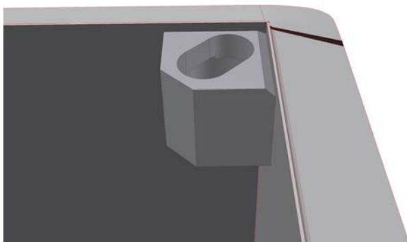
Figur 8-18. Lyftfästen inuti långtidsbeständig skärmad behållare för hårdkomponenter.
