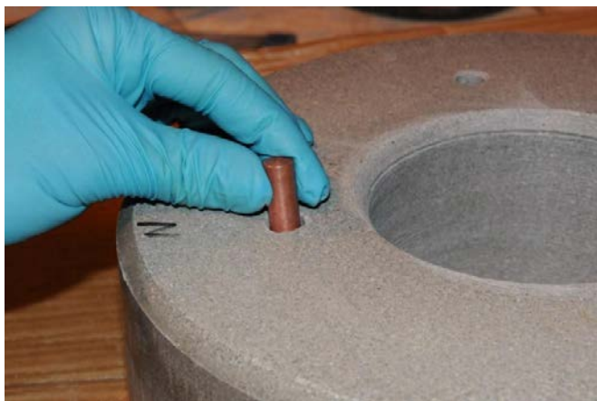
Figur 25-5. Kopparkutsar installerades i olika bentonitblock i de nyinstallerade ABM-paketerna 2012 för att öka kunskapen om eventuella interaktioner mellan bentonit och koppar.
