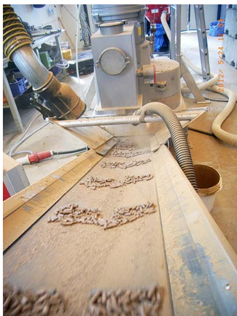
Figur 13-5. Tillverkning av extruderade pelletar i Bentonitlaboratoriet på Äspö.
