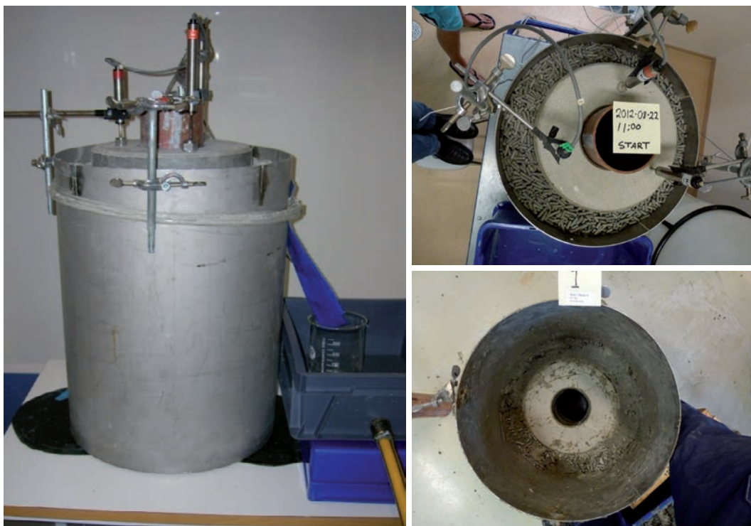
Figur 13-6. Försöksupställning för test av buffertens hävning. Bilden till vänster visar en översikt över testupställningen. Övre högra bilden visar bentonitblock och pelletar vid start av testet och nedre högra bilden är från brytningen av testet.
