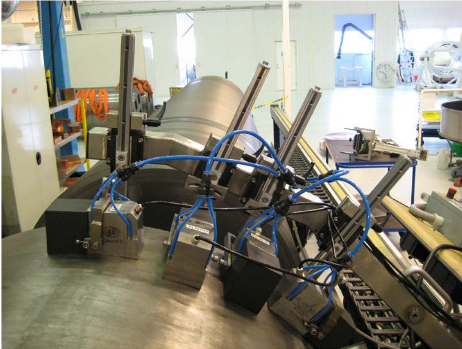
Figur 12-5. Fixtur med fyra stycken 32-elements linjärarrayer (1,7 MHz) för ultraljudsprovning av de yttre fem centimeterna med cirka 70° infallsvinkel med skjuvvågor.
