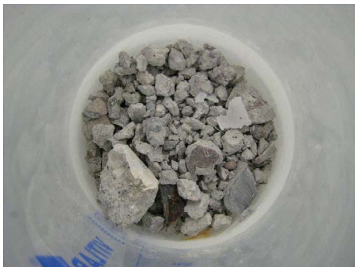
Figur 22-2. Betongprov från BMA efter frysning vid -5\text{ }^{\circ}\text{C} .
