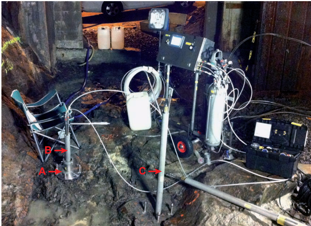
Figur 14-9. Test av utrustning för karakterisering av sprängskadezonens hydrauliska egenskaper. Till vänster ses borrhålsförlängaren (A) för vatteninjektering i det aktiva hålet. Injekteringsmanschetten (B) är förankrad i borrhålsförlängaren i nivå med bergytan. I mitten ses manschettsystem installerat i ett observationshål (C). Till höger ses vagnen med injektionssystem och datainsamlingsystem.
