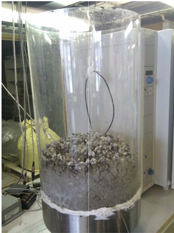
Figur 25-12. Bilden föreställer avslutat försök av det icke inspända systemet (det vill säga där bentoniten har fått svälla fritt), före exkavering (Birgersson och Goudarzi 2013).
