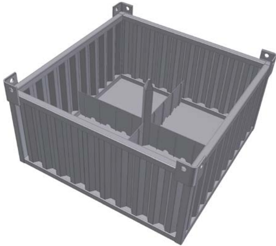
Figur 8-12. Behållare för fyra kokiller, tom. Förstyvningsplåtarna för bottenplåten och guider/styrningarna för kokillerna synliga.
