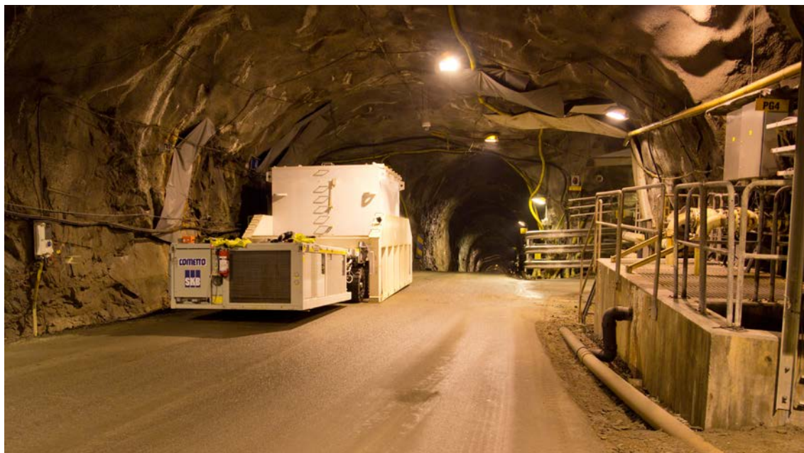
Figur 15-5. Foto av fordon med modifierad avfallstransportbehållare för att simulera framtida transporter av kapseltransportbehållare.
