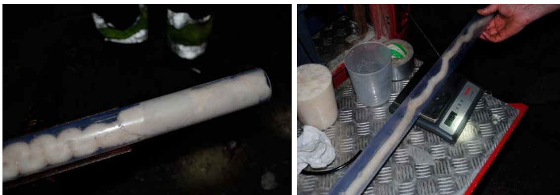
Figur 4-22. Kalibrering av laddutrustningen genom laddning av plexiglasrör. Till vänster: bottenladdning. Till höger: pippladdning konturhål 0,35 kg/m.
