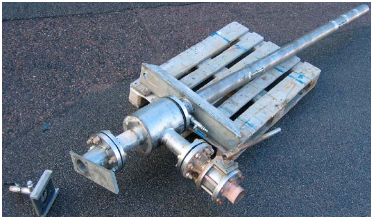
Figur 3-2. Rostfritt foderrör \varnothing 100/80 mm, längd 3 000 mm. På rörets vänstra ände är en förankringsbalk, T-rör och fläns monterad. På flänsen monteras den bultförsedda avledaren under borrning och mätning. På foderrörets högra del syns svarvade spår; till för att få ökad infästning i cementen.
