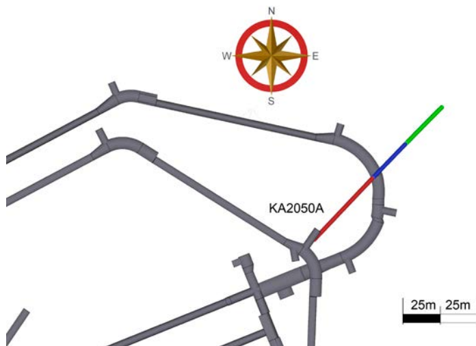
Figur 2-4. Kärnbränsleförvaret KA2050A i förhållande till planerad utbyggnadsvolym. De olika färgerna längs bränsleförvaret representerar de tre manschetterade sektionerna: sektion 6–101 m (röd), sektion 101–154 m (blå) respektive sektion 154–211 m (grön).
