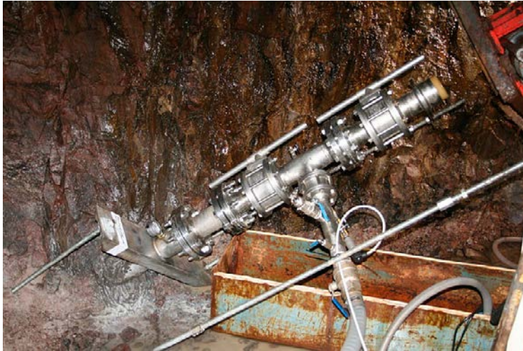
Figur 3-1. Ventilpaket som tagits fram vid kärnborrning i projektet Fintätning av tunnel på stort djup (SU32516), som användes vid borrning av de två förundersökningshål.
