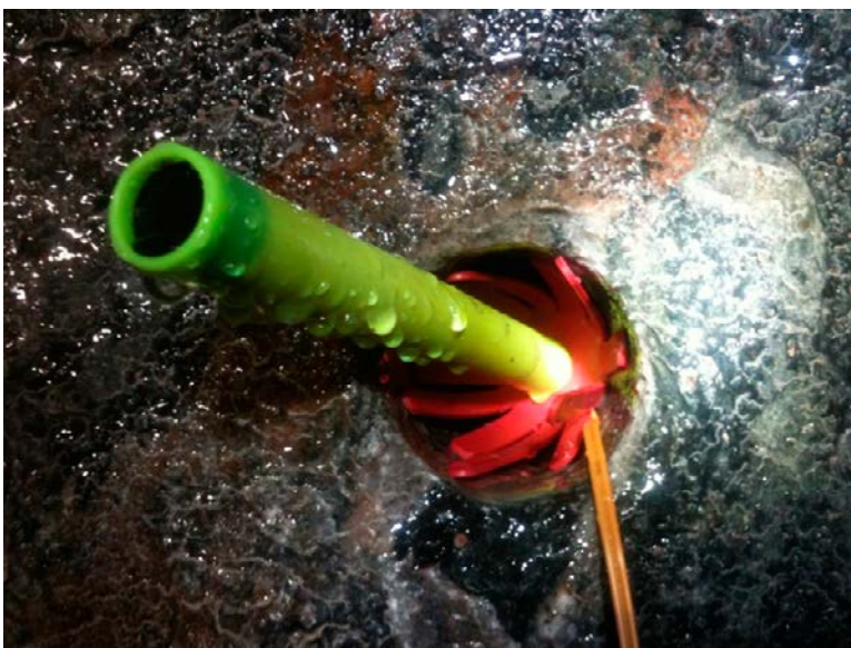
Figur 4-23. Spärrfjäder med borrar hål i vilken tändaren kan dras igenom och fästas i primern.
