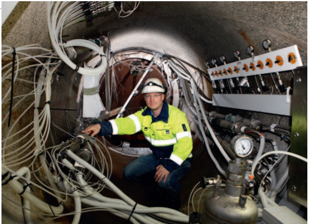
På 220 meters djup i Äspölaboratoriet och längst in i ett 95 meter långt hål har ett nytt försök med liggande kapslar installerats, berättar projektledare Magnus Kronberg.
