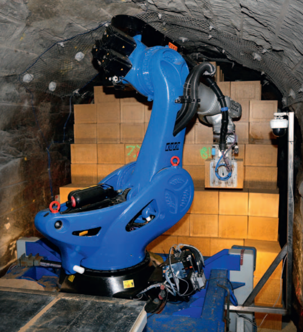
Det tog fyra dygn för den specialutvecklade roboten att återfylla tolv meter tunnel när den hårdtestades i Äspölaboratoriet tidigare i våras.
