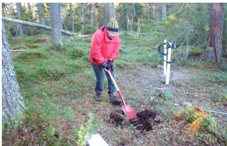
Figur 2-3. Provgrovsgrävning gjordes i november 2012 för att närmare undersöka glaciallerans utbredning vid den tilltänkta tillförselplatsen. Grundvattenrören SFM000132 och -134 syns till höger i bilden.
