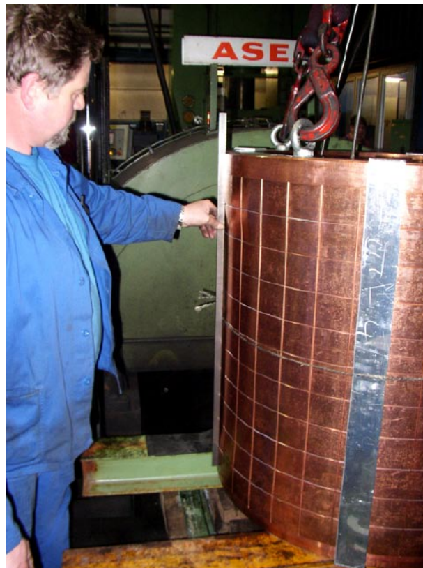
Figur 3-16. Provkapseln efter att ha varit utsatt för ett isostatiskt tryck på 135 MPa. Kopparhöljet har lokalt deformerats ca 20 mm. Kapseln var dock fortfarande tät.
