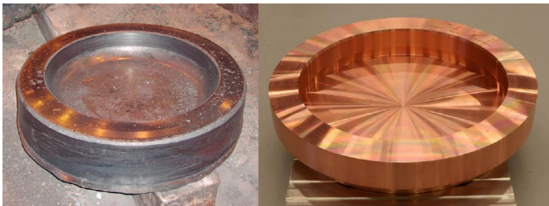
Figur 4-13 A och B. Foton av ett färdigsmitt lockämne (A), och ett lock nr TX 76, efter maskinbearbetning (B).
