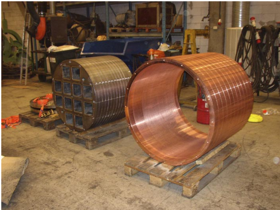
Figur 3-15. Del av insats I 26 och del av ett kopparrör för tryckprovning.
