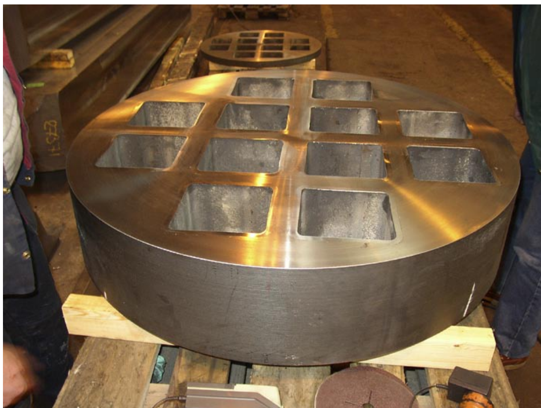
Figur 3-1. Kapade skivor ur gjuten insats för materialprovning
