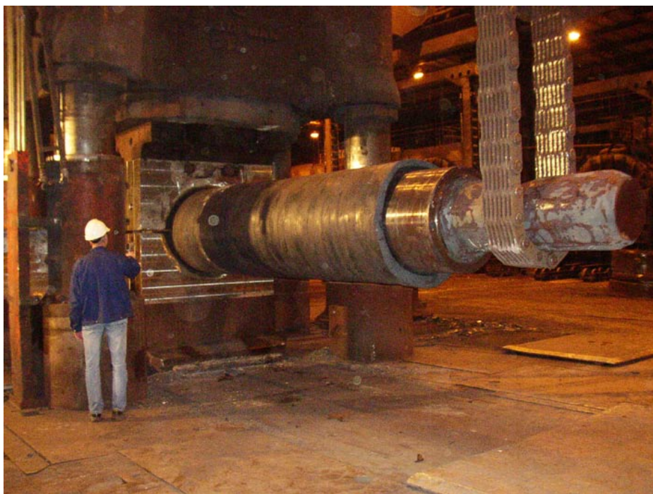
Figur 4-9. Slutliga räcksmidningsoperationen i det rundade verktyget.
