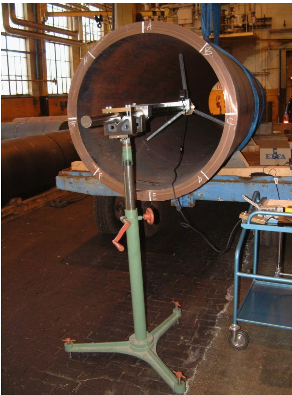
Figur 6-9. Invändig uppmätning av radien i ett kopparrör.
