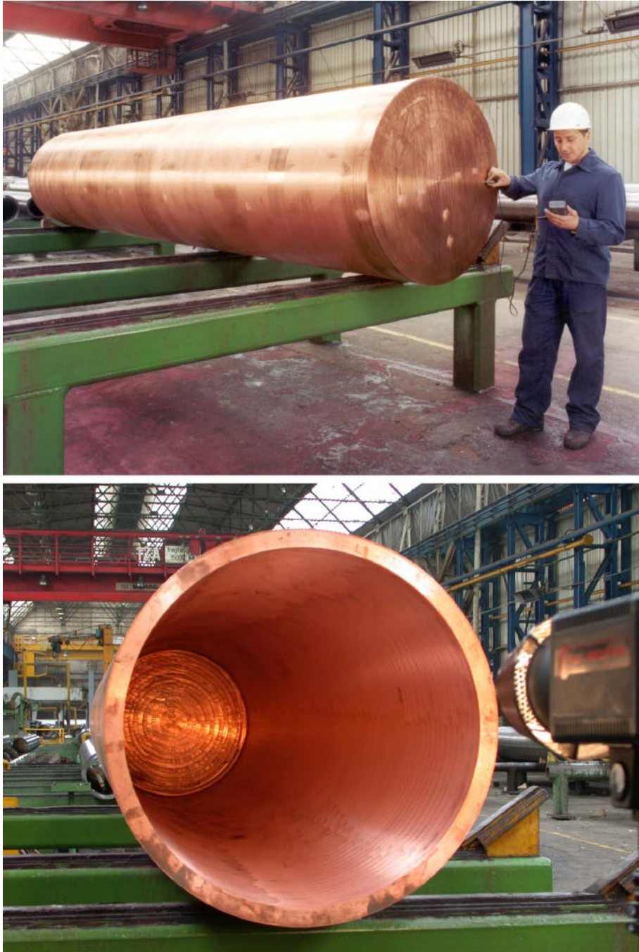
Figur 4-3. A och B. Rör T 34 med integrerad botten efter maskinbearbetning in- och utvändigt. Se även referens /13/.
