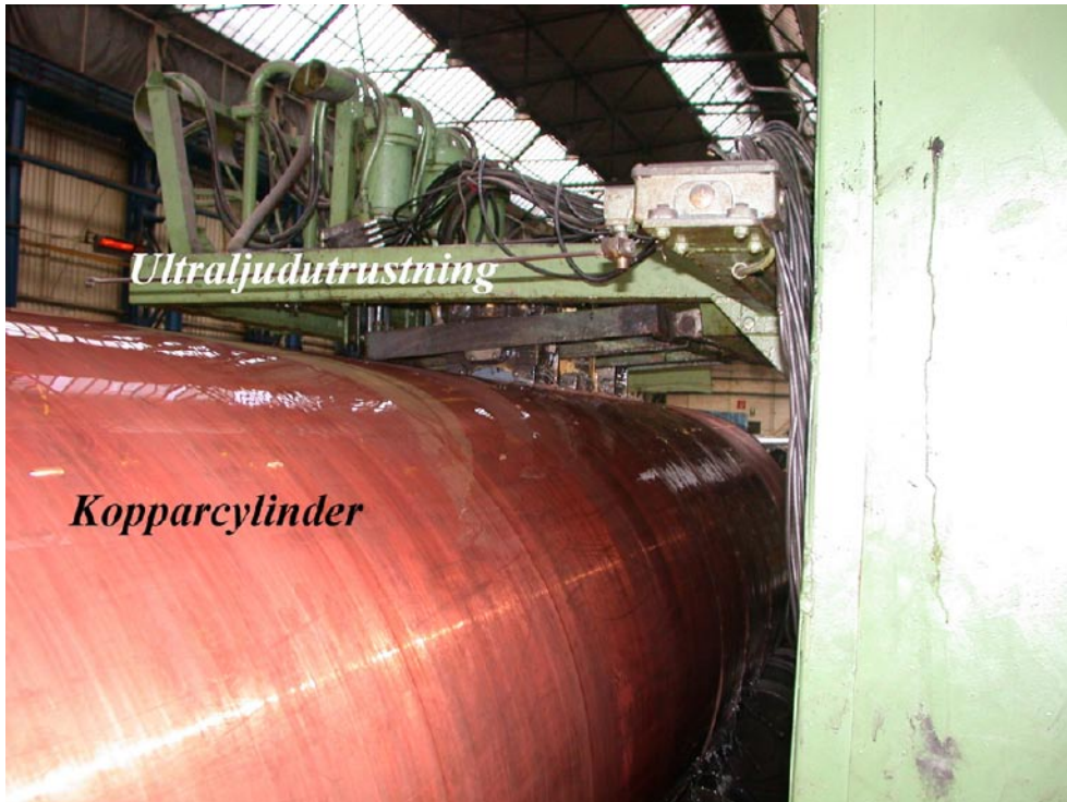
Figur 6-6. Provningsuppställning vid Vallourec & Mannesmann Tubes.
