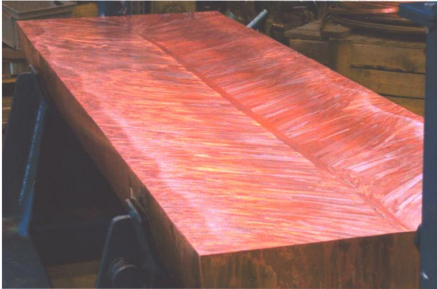
Figur 4-1. Kristallstruktur i ett delat koppargöt.
