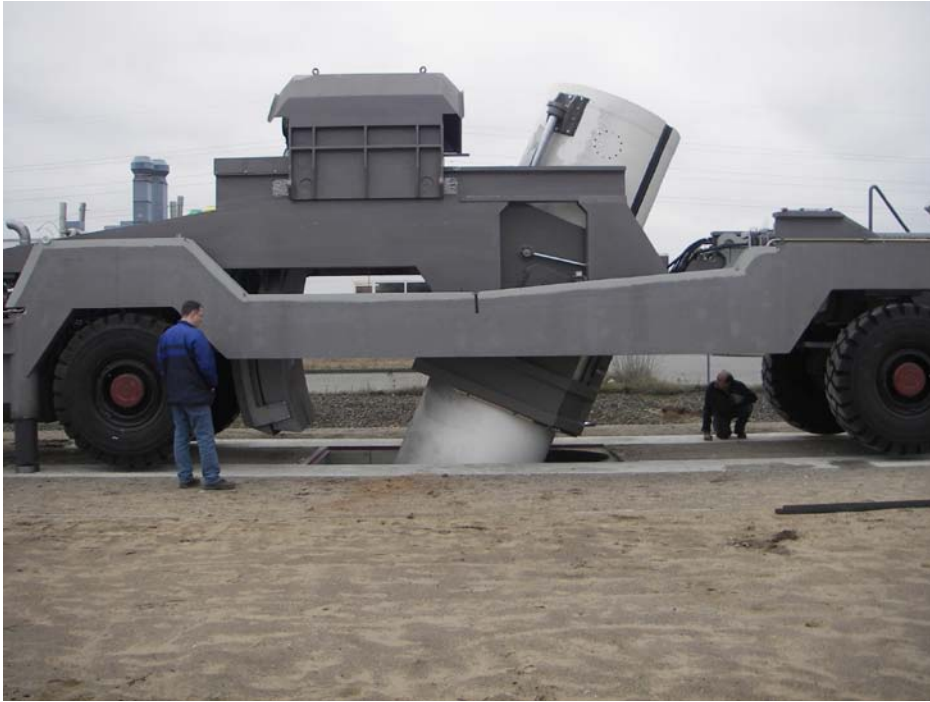
Figur 4-4. Prototyp av deponeringsmaskin med strålskärnstuben i delvis upprest läge.
