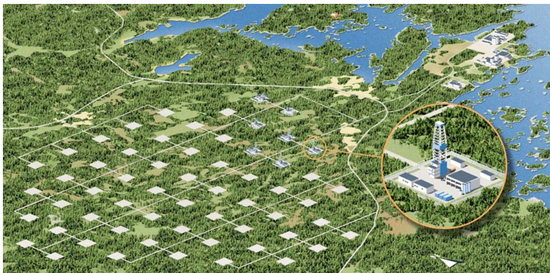
Figur 2-5. Exempel på layout för ett slutförvar enligt konceptet djupa borrhål med 60 deponeringshål vid Laxemar i Oskarshamns kommun (jmf. layout för ovanmarksdelen av ett KBS-3-förvar i Figur 2-3 ).
