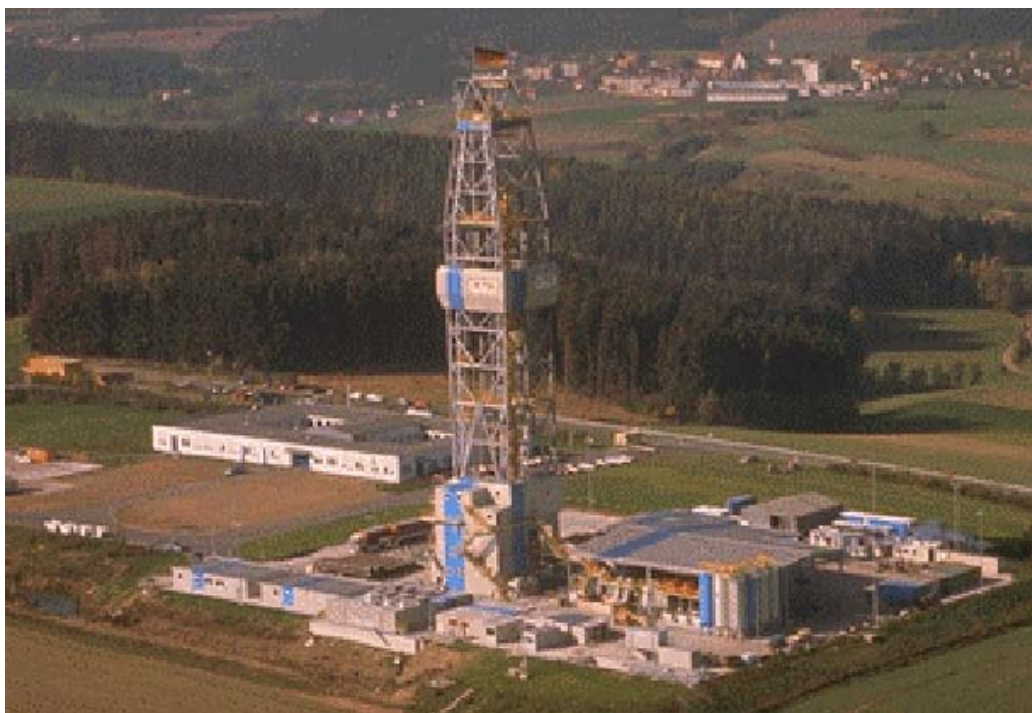
Figur 4-3. Borrhigg – UTB-1 GH 300 EG som användes i det kontinentala djupborrningsprogrammet i Tyskland /Harrison 2000/.
