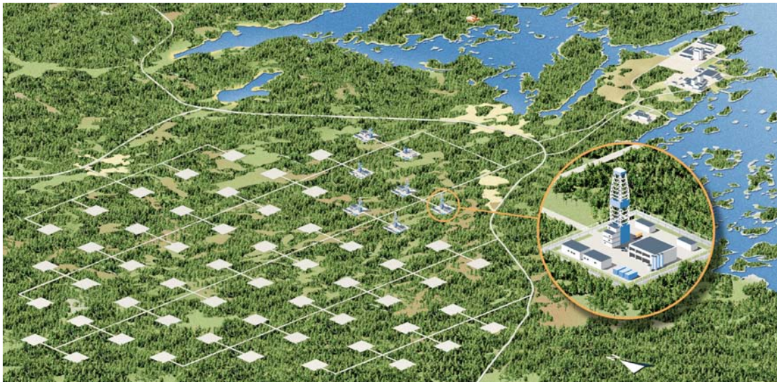
Figur 3-14. Exempel på layout för ett slutförvar enligt konceptet djupa borrhål vid Laxemar i Oskarshamns kommun. På bilden har 60 borrhål lagts in vilket är vad som skulle krävas för att rymma det använda bränslet från 50 års drift av reaktorerna i Forsmark och Ringhals samt 60 års drift av reaktorerna i Oskarshamn.
