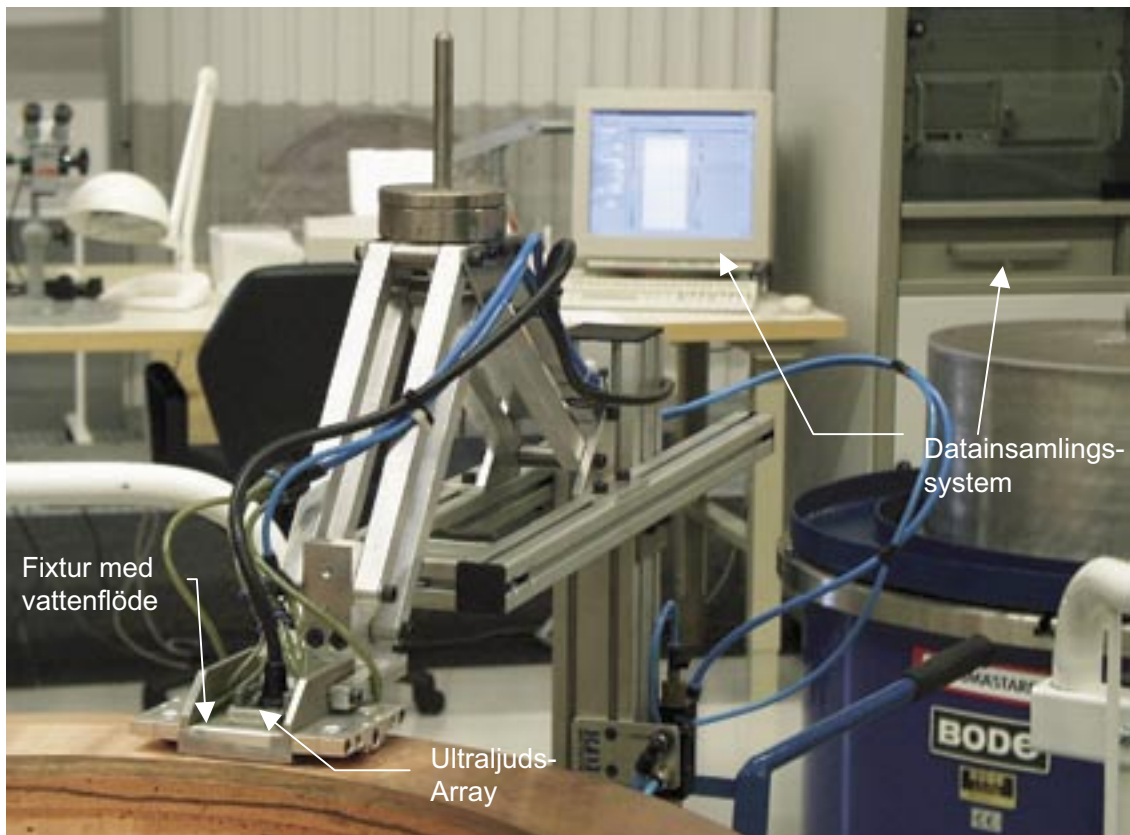
Figur 5-7. Ultraljudutrustning för inspektion av elektronstrålesvetsat kopparlock.
