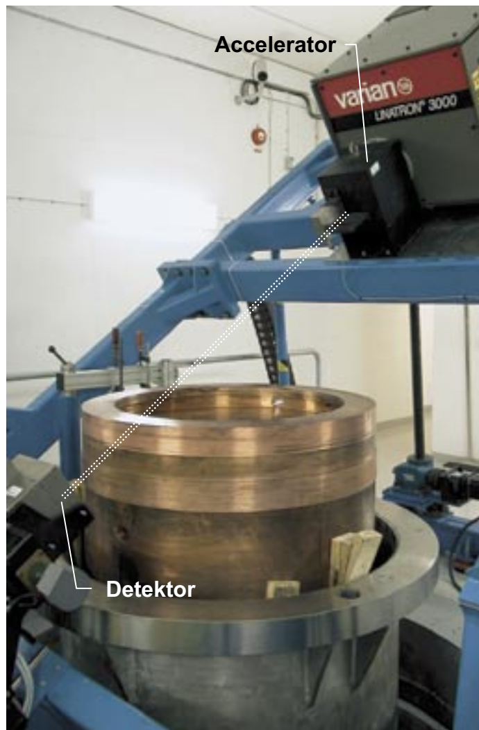
Figur 5-4. Röntgenutrustning för provning av elektronstrålesvetsat kopparlock.
