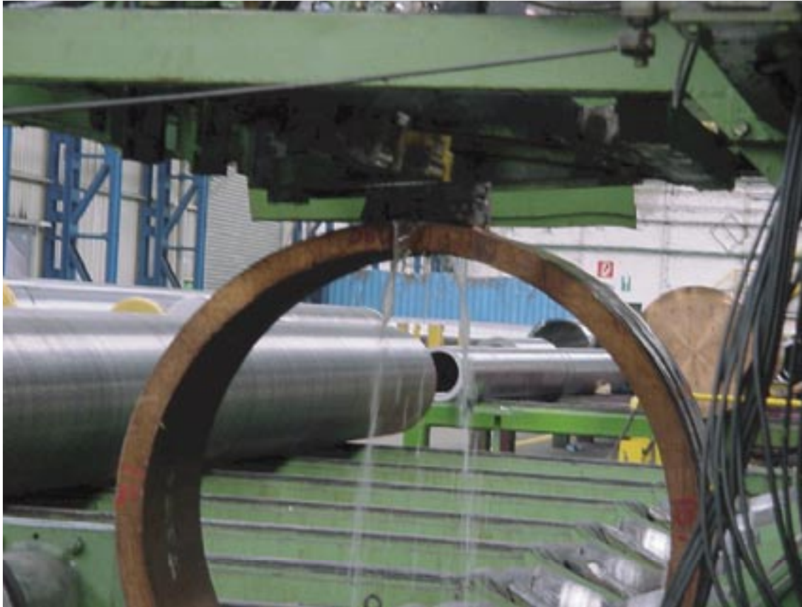
Figur 5-1. Provning av V&M referensring i den mekaniserade ultraljudanläggningen.
