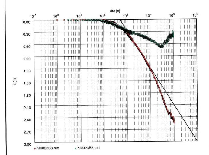
Transmissivity [m<sup>2</sup>/s]: 2.98 x 10<sup>-5</sup>
