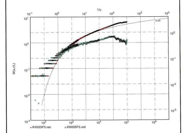
Transmissivity [m<sup>2</sup>/s]: 2.97 x 10<sup>-5</sup>
