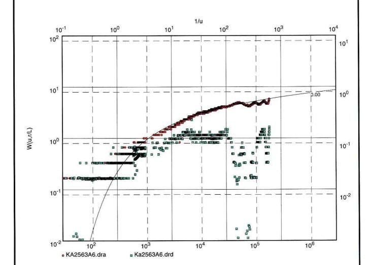
Transmissivity [m<sup>2</sup>/s]: 3.26 x 10<sup>-5</sup>
