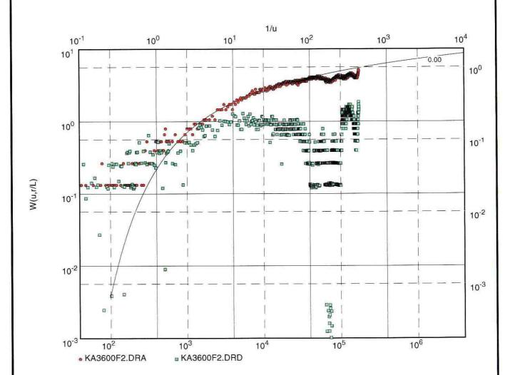
Transmissivity [m<sup>2</sup>/s]: 2.31 x 10<sup>-5</sup>
