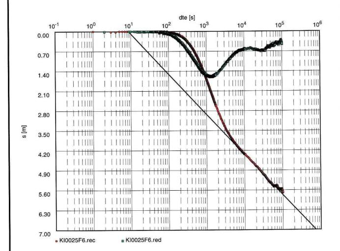
Transmissivity [m<sup>2</sup>/s]: 1.91 x 10<sup>-5</sup>
