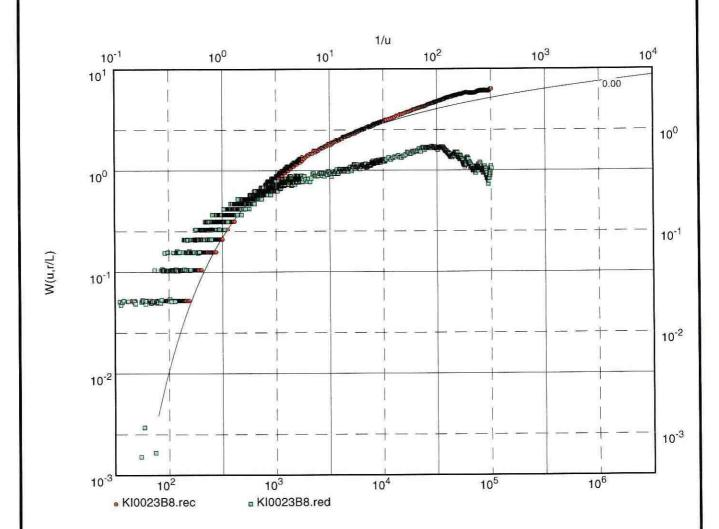
Transmissivity [m<sup>2</sup>/s]: 2.97 x 10<sup>-5</sup>
