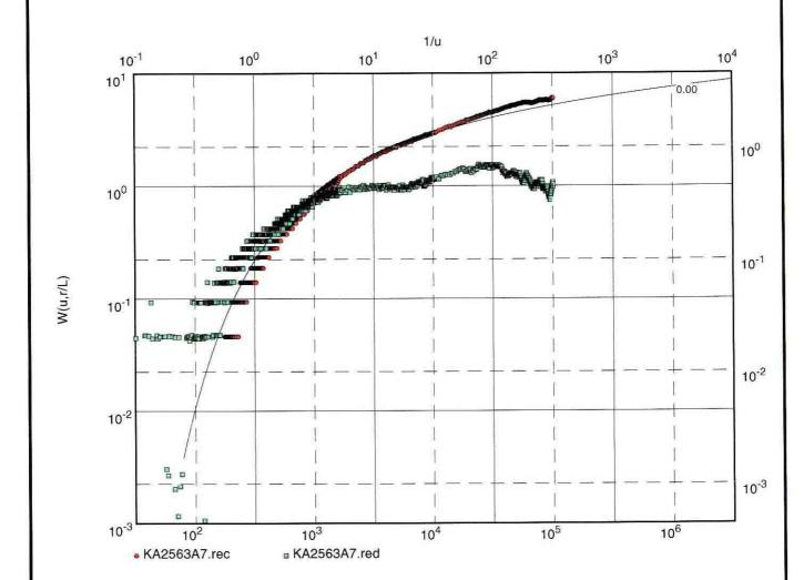
Transmissivity [m<sup>2</sup>/s]: 2.65 x 10<sup>-5</sup>
