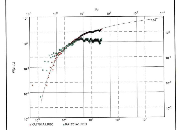
Transmissivity [m<sup>2</sup>/s]: 2.97 x 10<sup>-5</sup>
