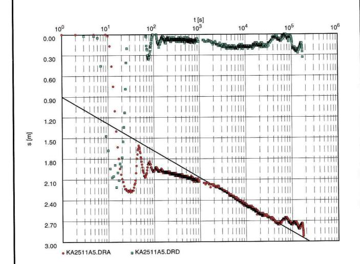
Transmissivity [m<sup>2</sup>/s]: 2.42 x 10<sup>-5</sup>
