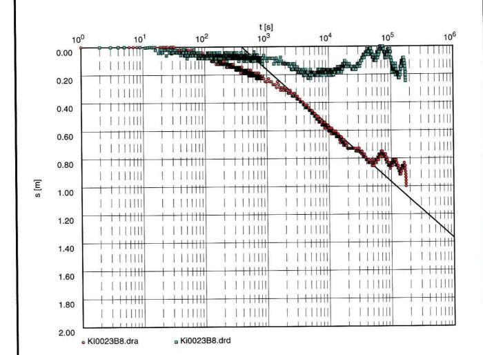
Transmissivity [m<sup>2</sup>/s]: 2.34 x 10<sup>-5</sup>
