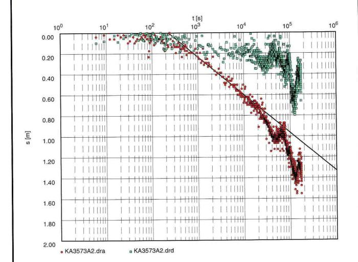
Transmissivity [m<sup>2</sup>/s]: 3.45 x 10<sup>-5</sup>
