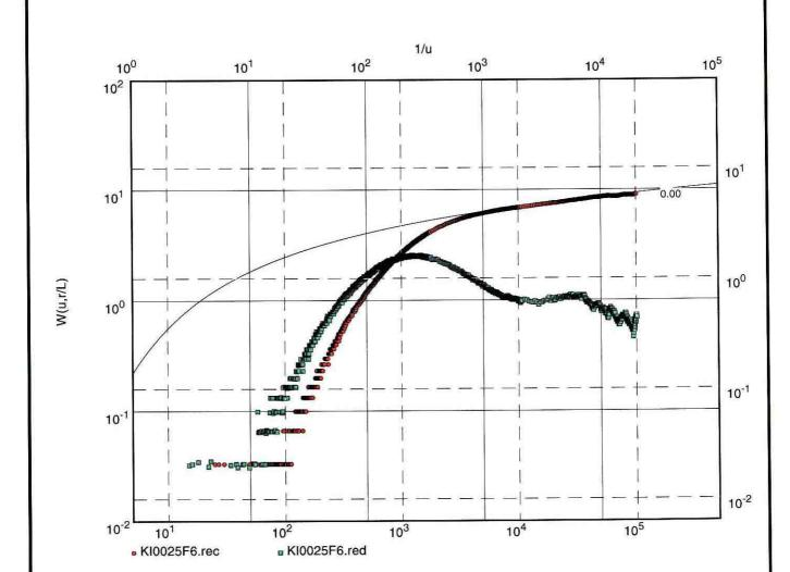
Transmissivity [m<sup>2</sup>/s]: 1.87 x 10<sup>-5</sup>
