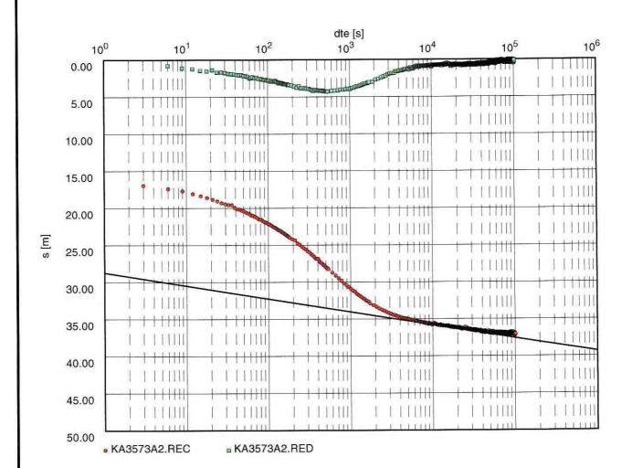
Transmissivity [m<sup>2</sup>/s]: 1.54 x 10<sup>-5</sup>
