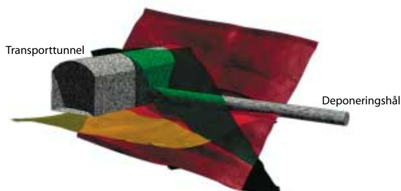
Figur 1-3. KBS-3-metoden där kapslarna deponeras horisontellt efter varandra i 200–250 meter långa deponeringshåll. Utformningen innebär att de deponeringstunnlar, som finns i referensutformningen inte behövs.
