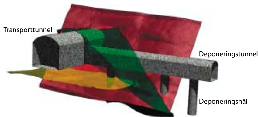
Figur 1-2. Referensutformning av KBS-3-metoden med vertikal deponering.
