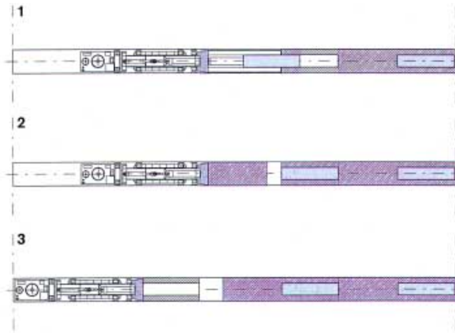
Figur 2-5. Principen för deponering där 1) visar inplacering av kapseln i bufferten, 2) visar installation av en bentonitplugg och 3) visar installation av den cylindriska bufferten, varefter en ny deponeringscykel kan inledas.
