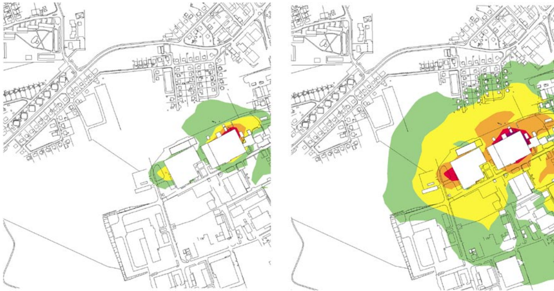
Figur 3-5. Jämförelseexempel där samma verksamhet redovisas med riktvärde för dagperioden (50 dBA) i den vänstra bilden och för nattperioden (40 dBA) i den högra.
