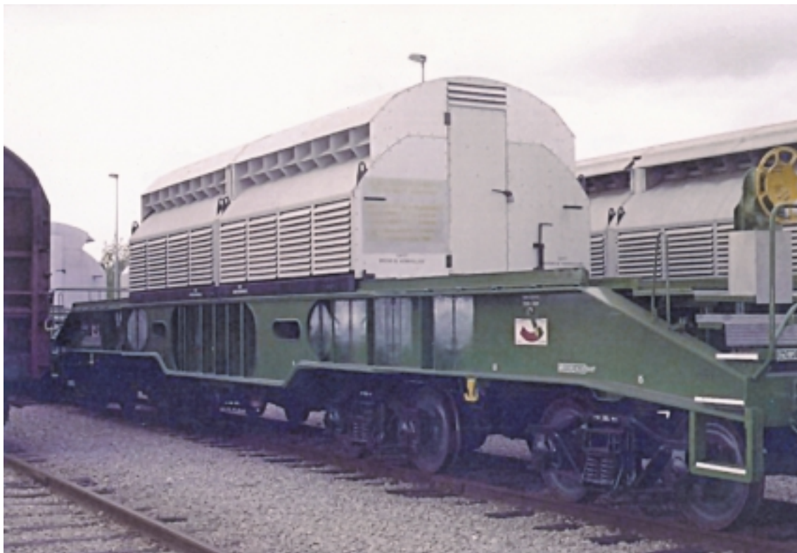
Figur 4-4. Järnvägsvagn för transport av använt kärnbränsle med en transportbehållare typ B.
