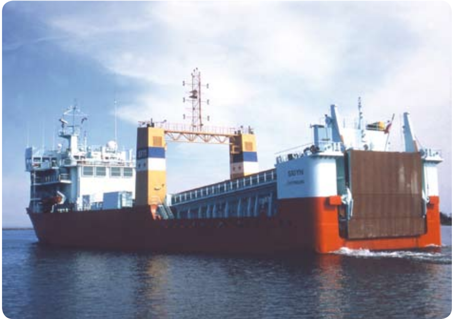
Fartyget är ett kombinerat endäckat och dubbelbottnat ro/ro och lo/lo fartyg och ämnat för tunga lastenheter.
