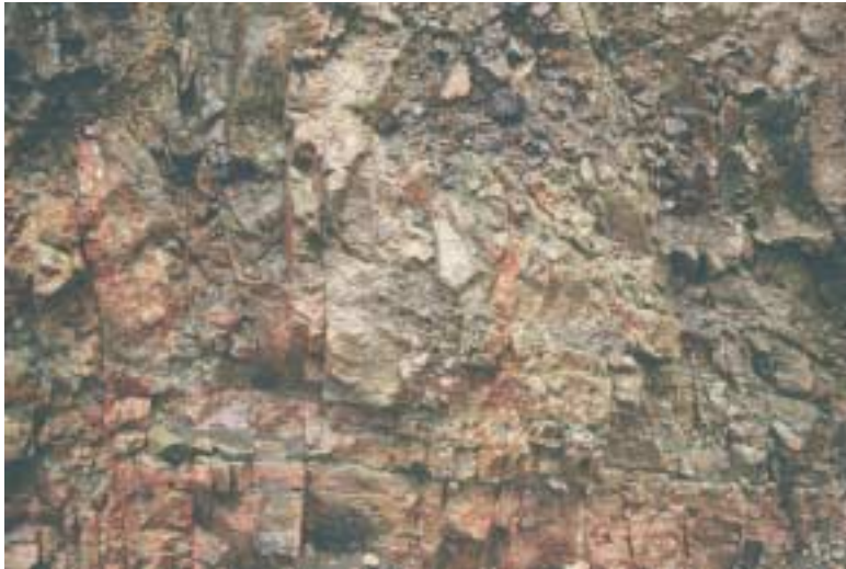
Figur 3-6. Sprickzon med minst tre olika sprickgrupper.
