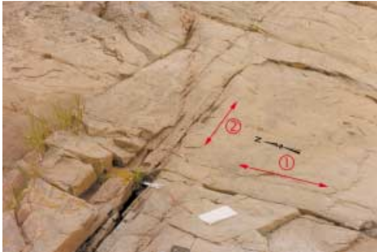
Figur 3-5. Häll med tre sprickgrupper. Två är branta och stryker N respektive O, en tredje grupp är flack.
