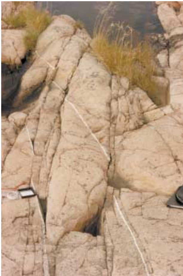
Figur 3-2. Med hjälp av plana markörer av olika riktning (t ex de ljusa kvartsgångarna i figuren) kan en förkastnings rörelsevektor beräknas.
