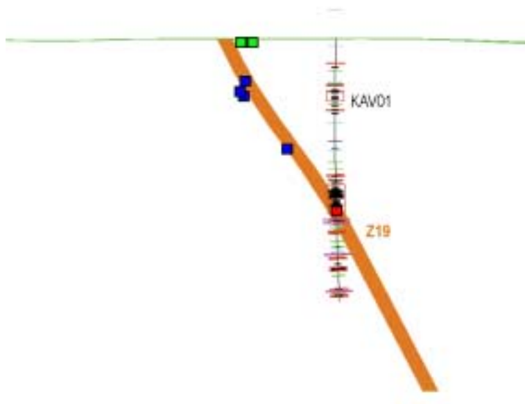
Figur 4-19. Profil av Z19 efter ommodellering. Seismikpunkter i blått, markytepunkter i grönt, borrhålspunkt i rött, se Tabell 4-4.
