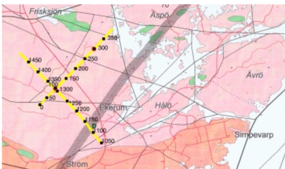
Figur 2-2. Berggrundsgeologisk karta med de seismiska linjerna (gula) och CDP nummer. CDP – Common Depth Point Linje 1 (SV-NO) och Linje 2 (SO-NV), modifierad efter Bergman et al /1998, 2000/.
