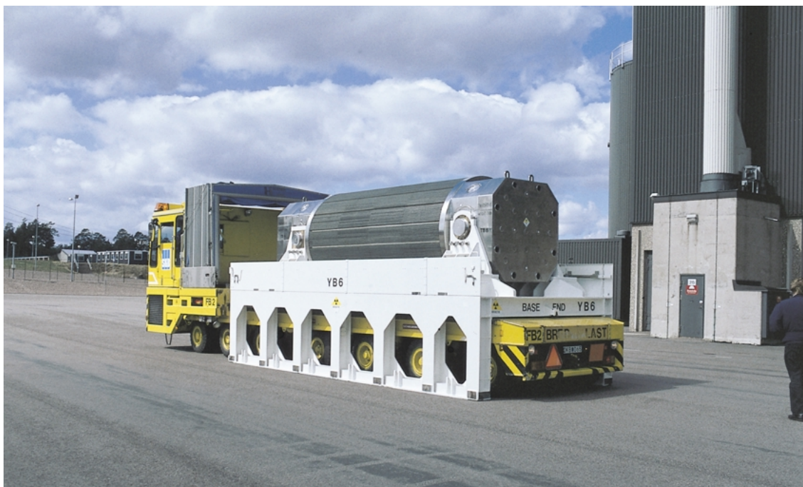
Figur 6-3. Terminalfordon med transportbehållare för använt kärnbränsle.
