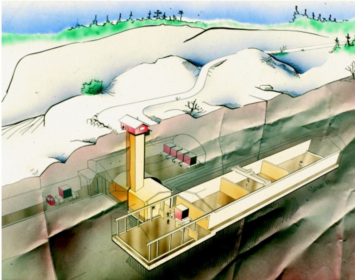
Figur 5-16. Bergrumsanläggningen för mellanlagring av radioaktivt avfall vid Studsvik. Översiktsbild (modifierad efter /5-6/).
