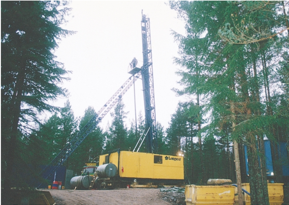
Figur 2-1. Kärnborrning på en iordningställd borrplats med väganslutning.
