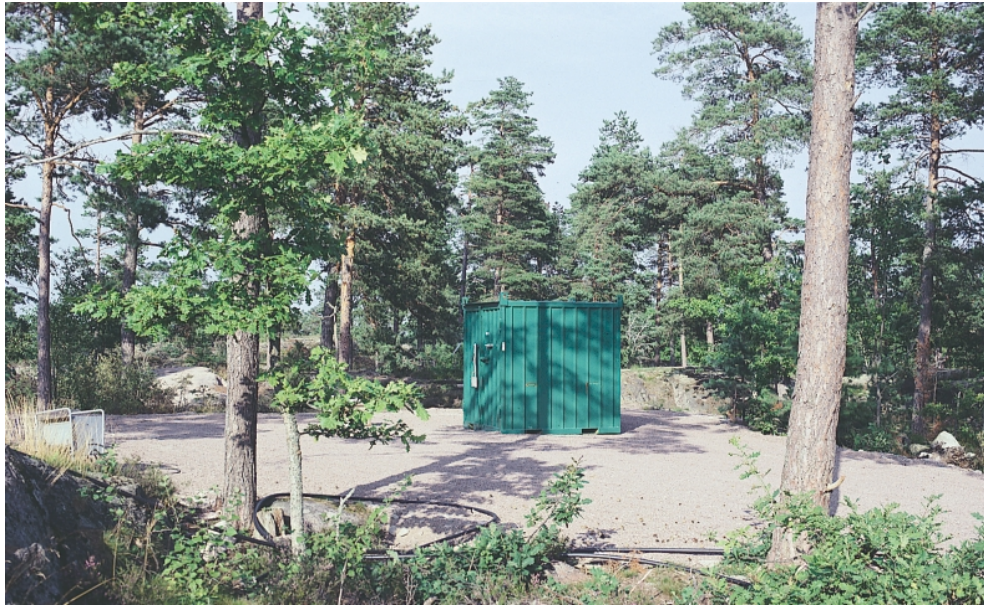
Figur 2-2. Borrplats med mätcontainer placerad över färdigt borrhål, i detta fallet med utrustning för långtidsmonitoring av grundvattennivåer.
