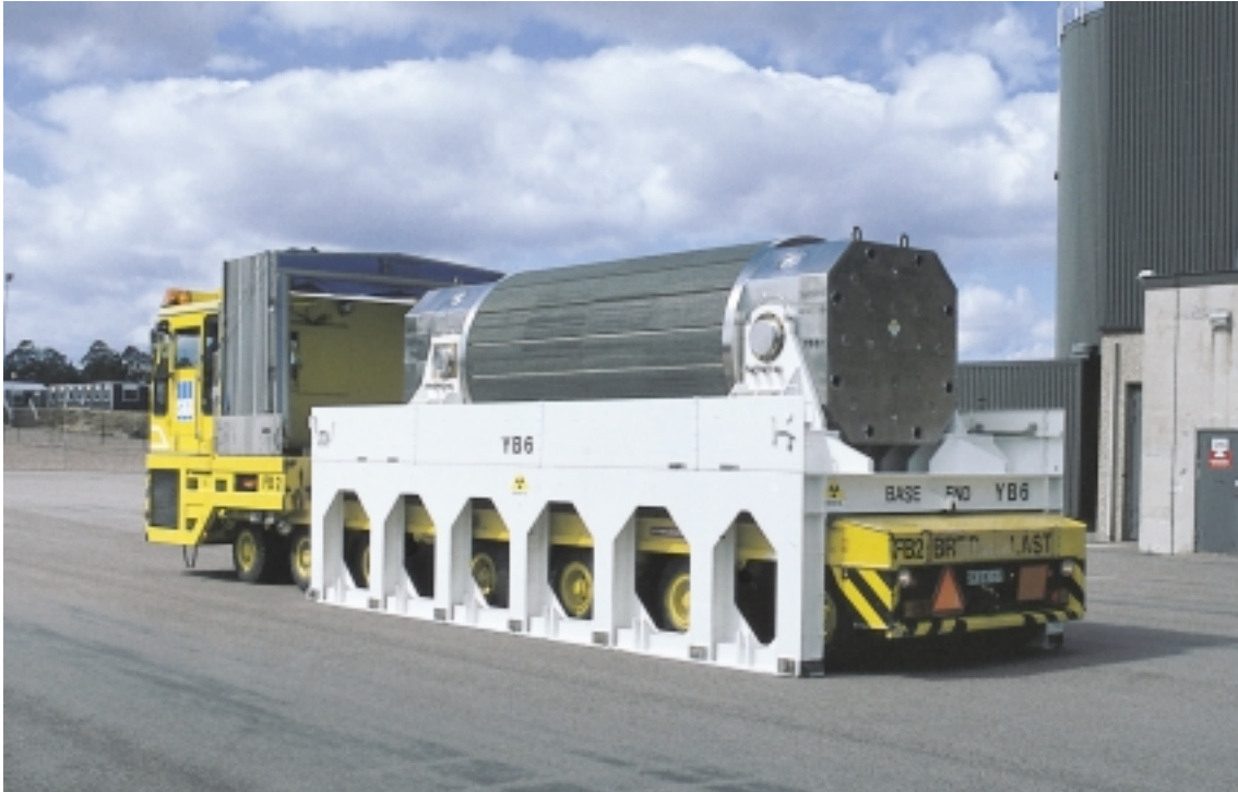
Figur 3-3. Terminalfordon med transportbehållare för använt kärnbränsle.
