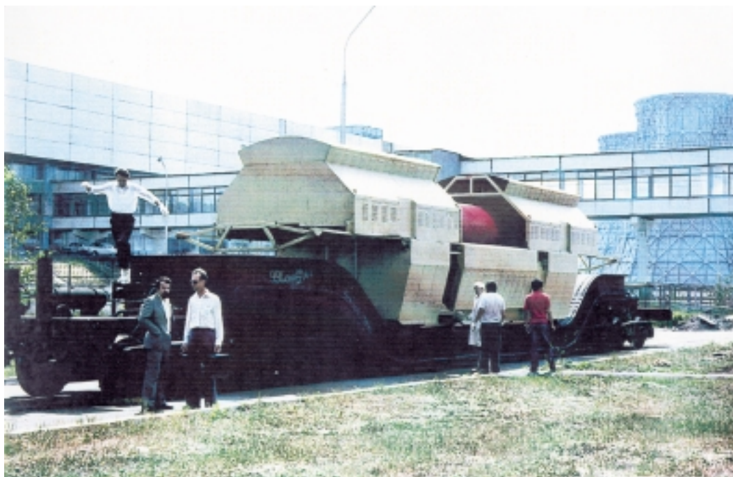
Figur 3-6. Transportbehållare på järnvägsvagn med väderskydd.
