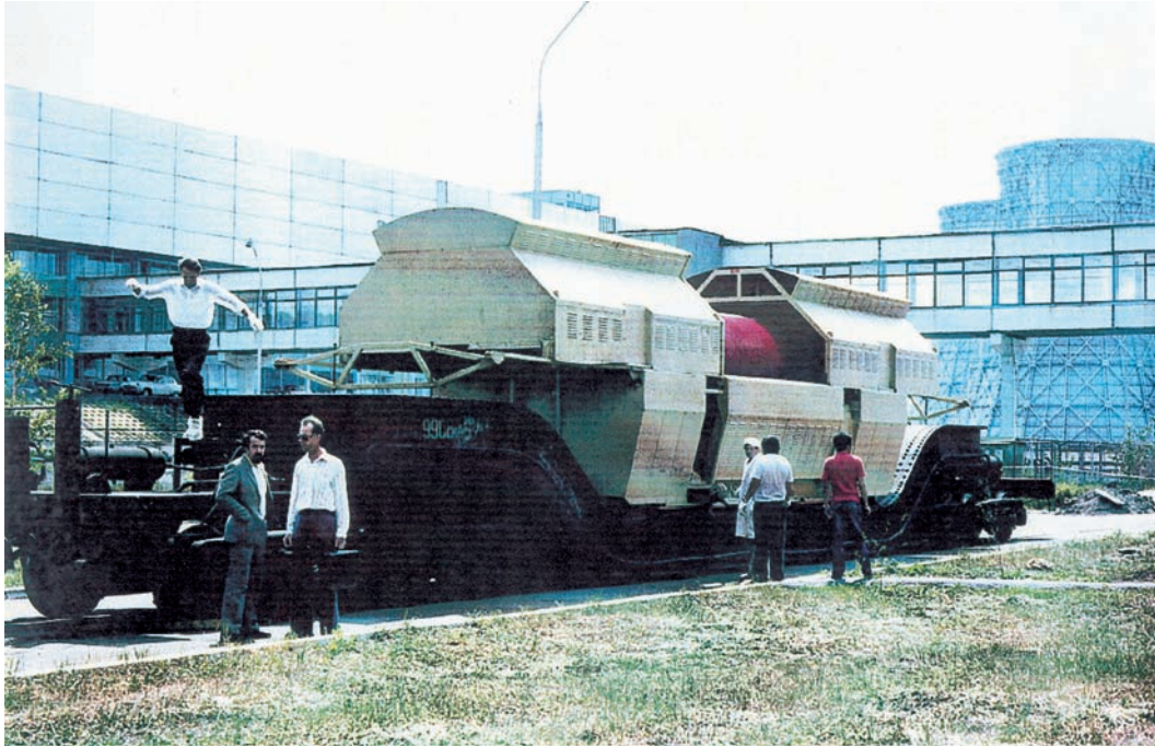
Figur 3-6. Transportbehållare på järnvägsvagn med väderskydd.
