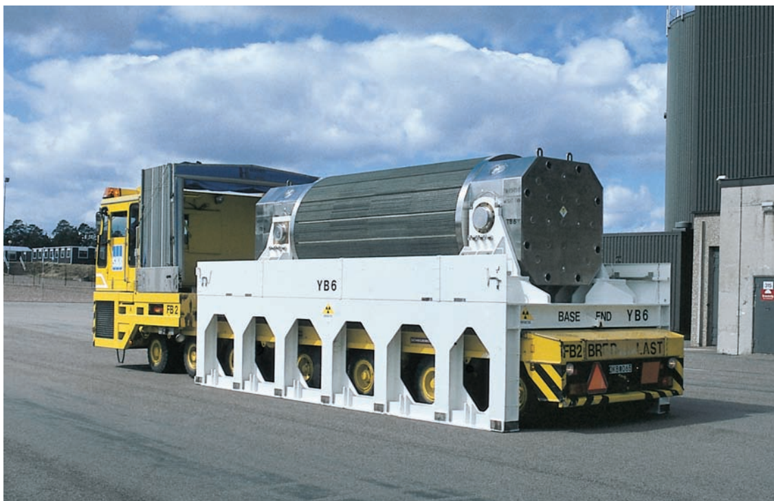
Figur 3-3. Terminalfordon med transportbehållare för använt kärnbränsle.
