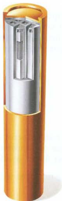
Figur 3-5. Utformning av kapselns hölje och insats.
