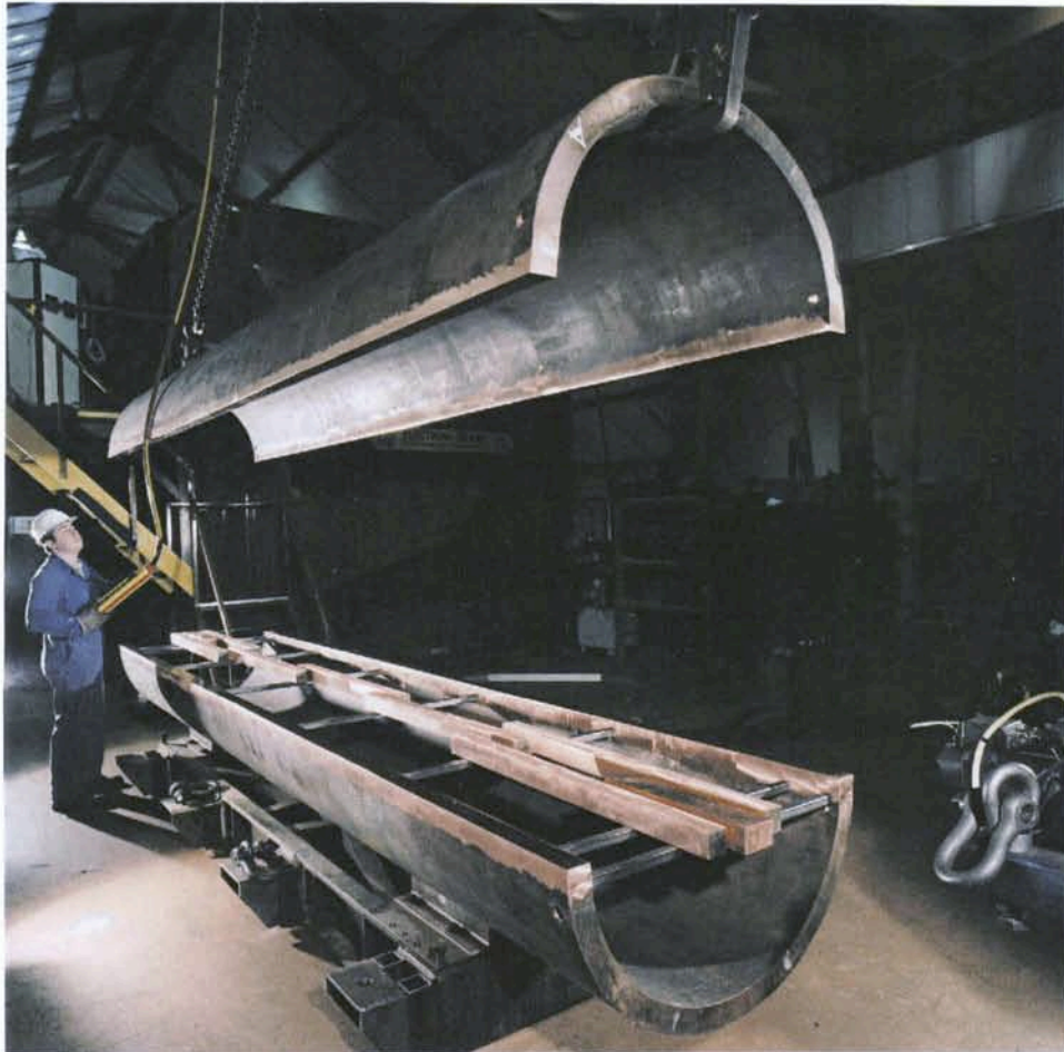
Figur 3-4. Sammansättning av rörhalvor för elektronstrålesvetsning. Kopparrängerna i mitten har placerats där för att stoppa elektronstrålen så att den inte träffar den andra väggen under längssvetsningen.
