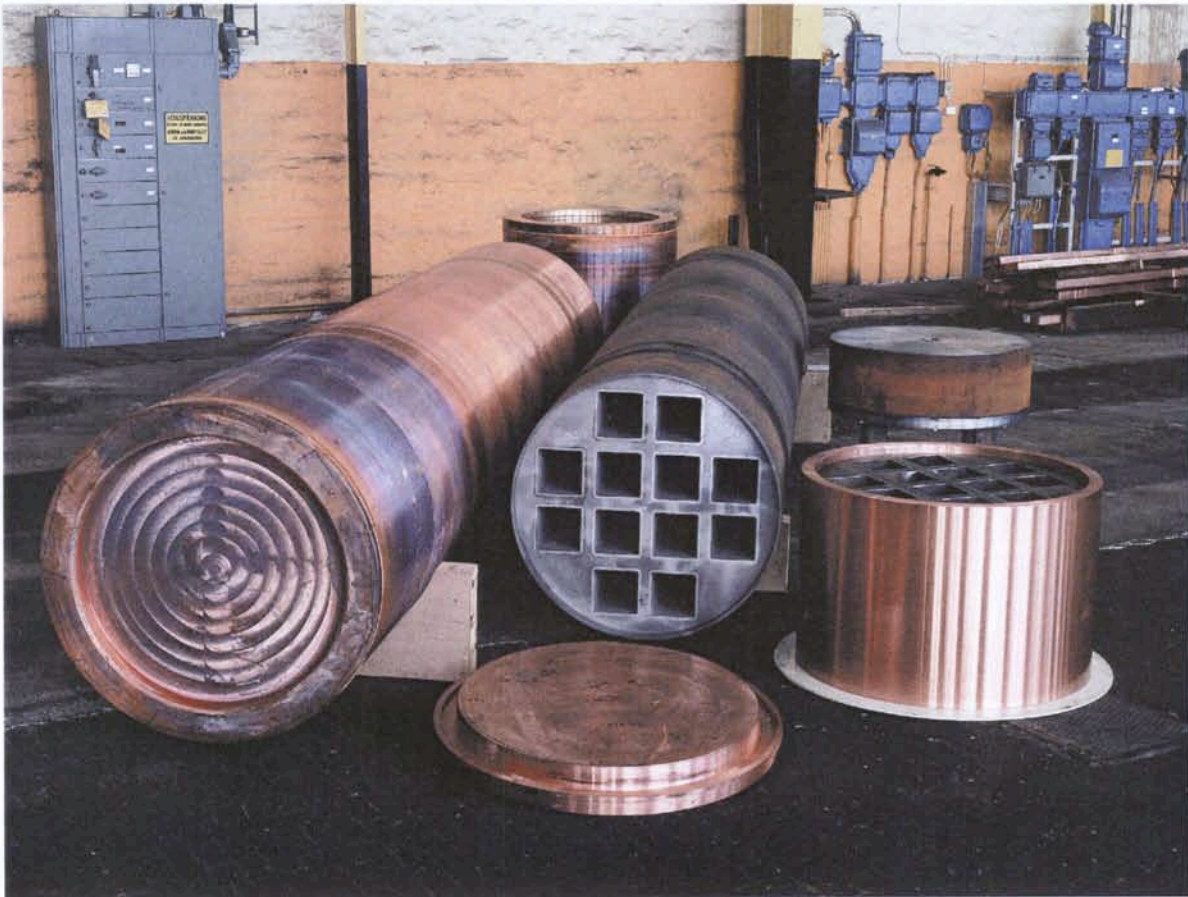
Figur 1-1. Provtillverkning av kapslar. Bilden visar en kopparkapsel med gjuten insats, ett lock i koppar samt några utställningsföremål.
