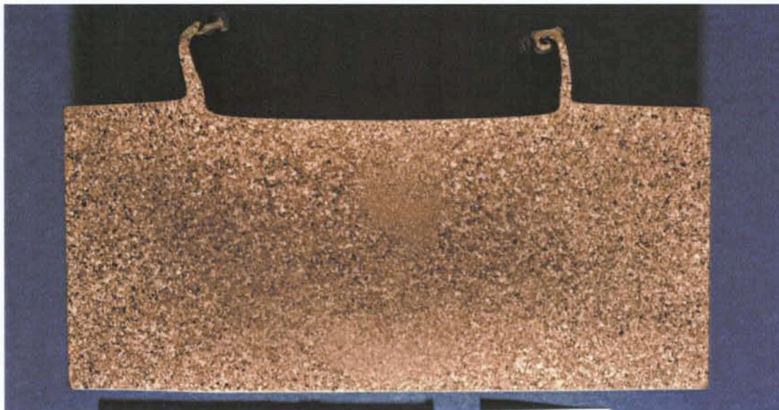
Figur 5-6. Svetszonen i 40 mm tjocka kopparplåtar efter FSW.
