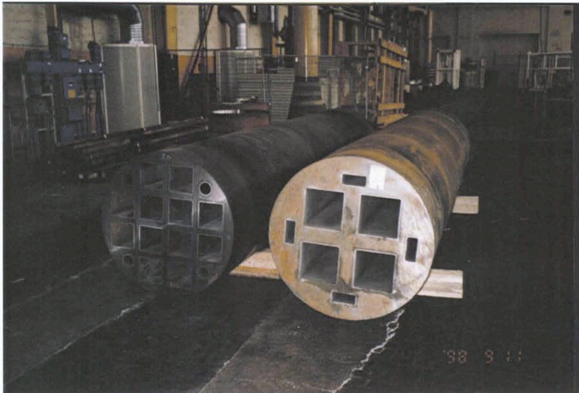
Figur 4- 10. Gjutna insatser i segjärn enligt den utvecklade konstruktionen med extra "kylrör" för jämnare gods fördelning. Insats I 11 till vänster i bilden och den första PWR-insatsen som tillverkats till höger.
