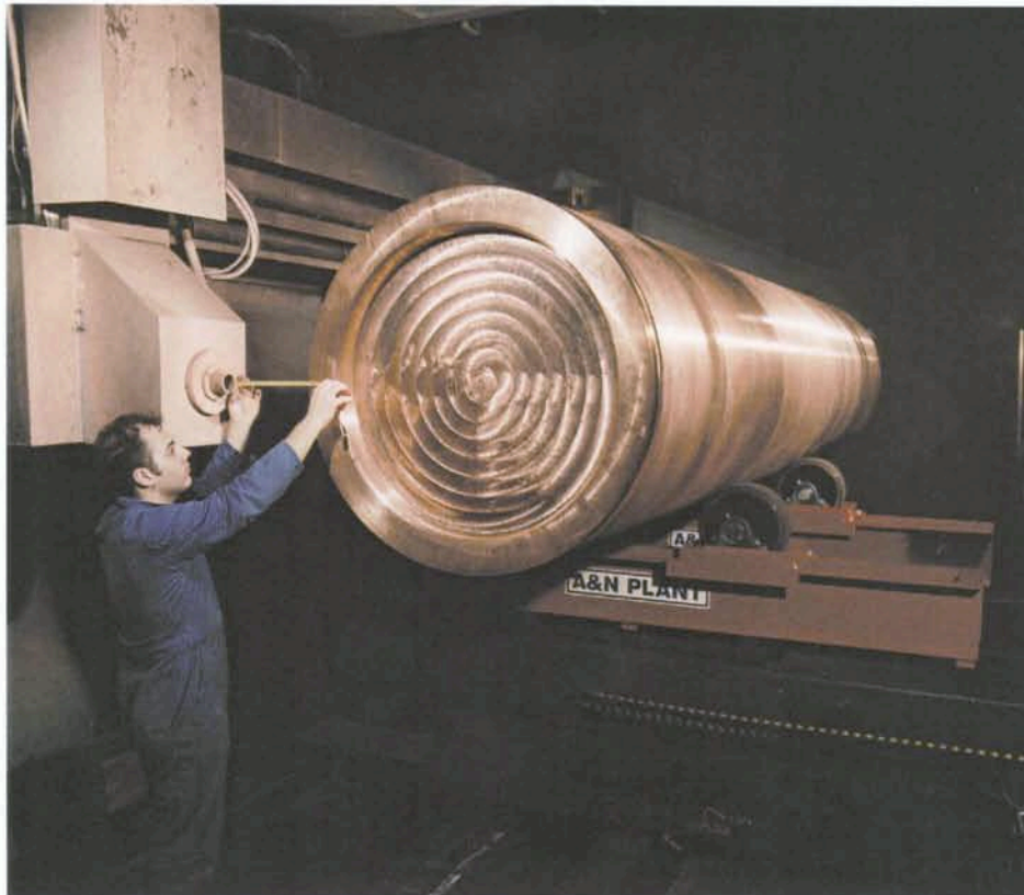
Figur 4- 3. Rör T 9 i vakuumkammaren för svetsning av botten. Bilden visar även elektronkanonens placering. Vid svetsningen roterar röret medan elektronkanonen är fast.
