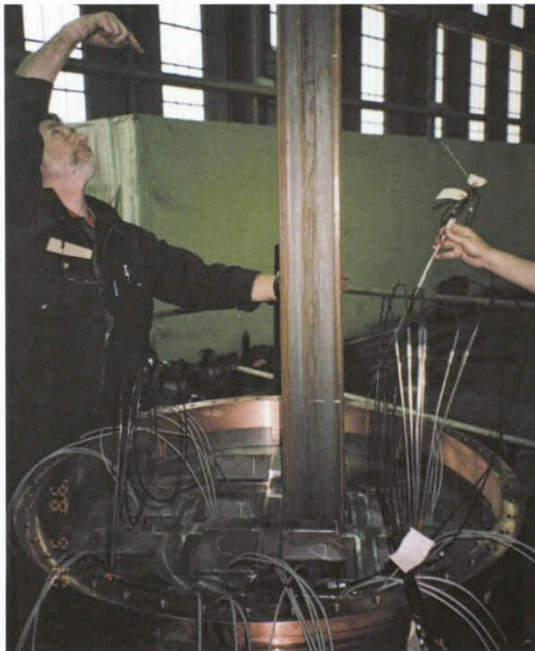
Figur 4-12. Värmelement med samma mått som BWR-bränslet placeras i insatsens kanaler. Kapseln är försedd med ett antal termoelement både invändigt och utvändigt.
