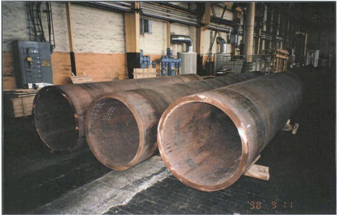
Figur 3-12. Extruderade kopparrör. Liksom med dornpressning blir sista momentet i tillverkningen av kopparrör med denna metod in- och utvändigt maskinbearbetning.
