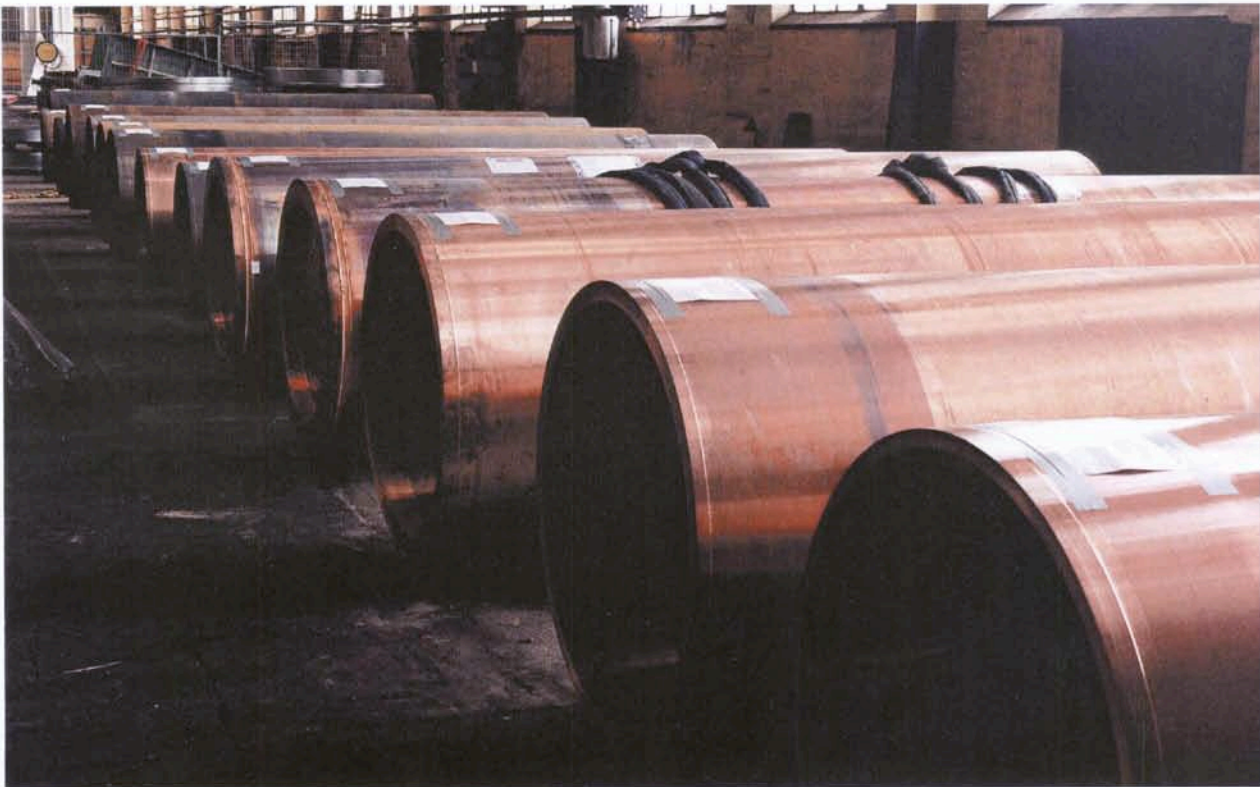
Figur 1-2. Provtillverkning av kapslar. Bilden visar kopparrör ock insatser. Ett par av kopparrören har påsvetsad botten.
