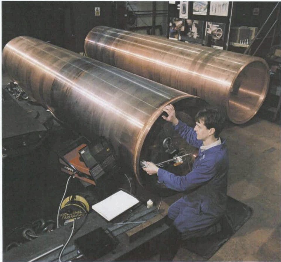
Figur 4- 4. Ultraljudprovning (P-scanning) av bottensvets TB 3/T 9.
