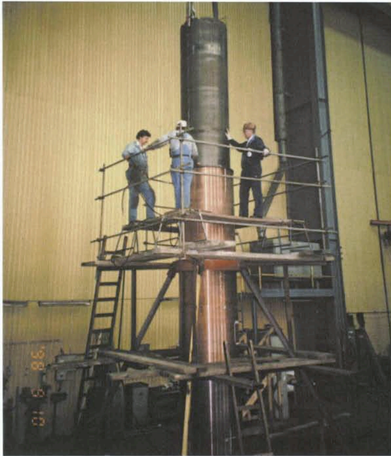
Figur 4-11. Hopsättning av komplett kapsel, C 3. Insatsen (I 10) sänks ned i kopparhöljet (T 9 och TB 3).
