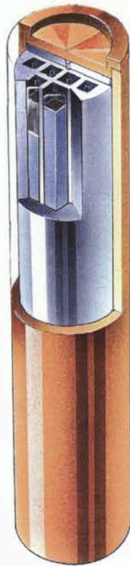
Figur 2-1. Kopparkapsel med gjuten insats med plats för 12 st BWR-element.
