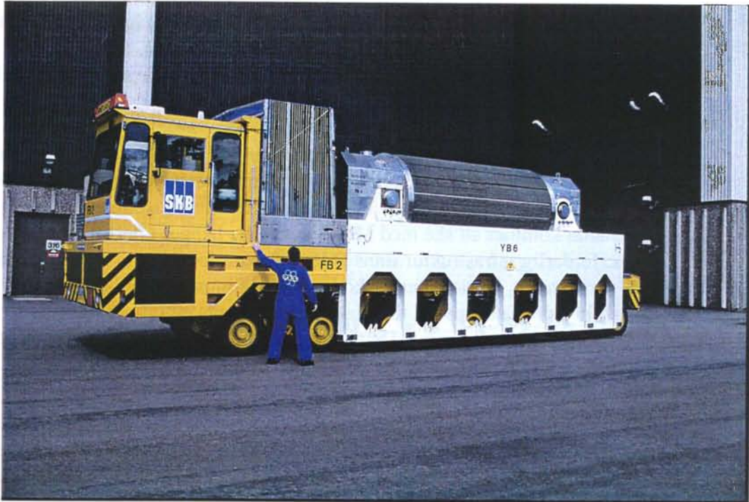
Figur 1-1. Transportbehållare för bränsleelement på transportfordon.
